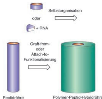
**Auf die richtige Verpackung kommt es an:** Selbstorganisierte Peptidröhren werden durch effiziente Oberflächenpolymerisation oder das Anheften von Polymeren mit Polymerhüllen umwickelt (siehe Schema). Durch das Anbringen einer Polymerhülle lassen sich die Eigenschaften der Peptidröhre modifizieren; die so entstehenden Peptid-Polymer-Hybride sind äußerst interessant für zukünftige Anwendungen.
